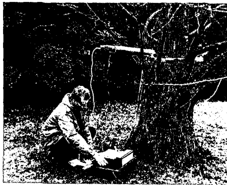
Abb. 2: Untersuchung eines Urwelt-Mammutbaumes mit dem DENSITOMAT. Zur Feldausrüstung gehören ein Bohrgerät, Halterung, Akku sowie Schreiber oder Feldcomputer.
